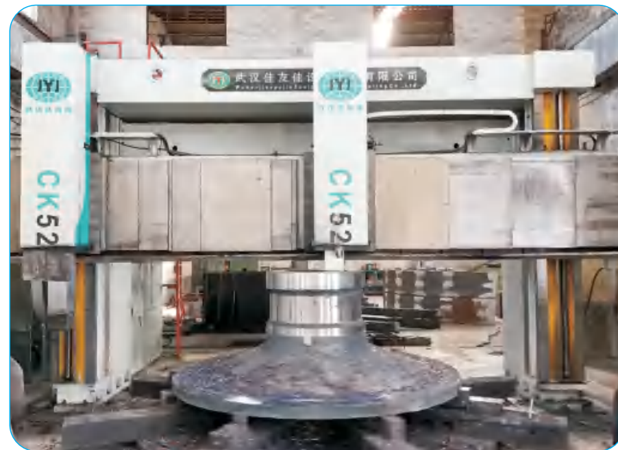
φ8米数控立车 φ 8m CNC vertical lathe
