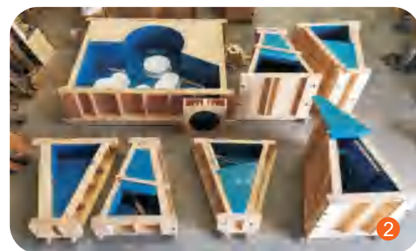
木模制作 Wooden Pattern making
