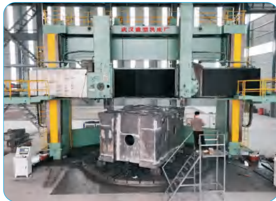
φ10米数控立车 φ10m CNC vertical lathe
