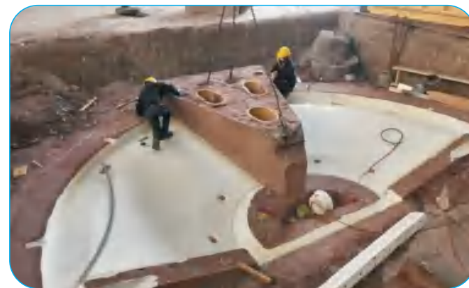
水玻璃砂造型 Sodium silicate sand molding
