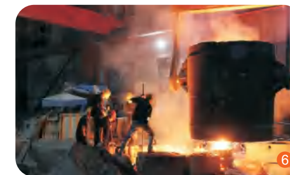
钢水浇注 Molten steel pouring
