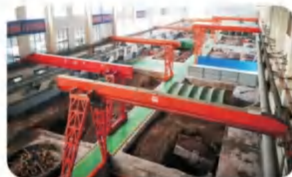
地坑造型 Pit Molding
