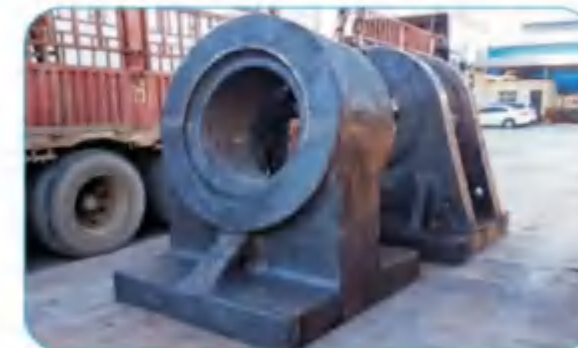
国家重点工程一大藤峡水利枢纽工程定制 铰链、铰座 National key project - Dateng Gorge water conservancy project customization Hinge, hinge seat
