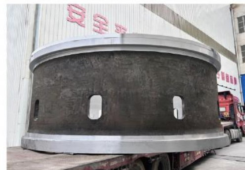
中间筒 Cylinder liner
